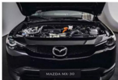
Unter der Haube befinden sich der Elektromotor für den Antrieb und der Kreiskolbenmotor
