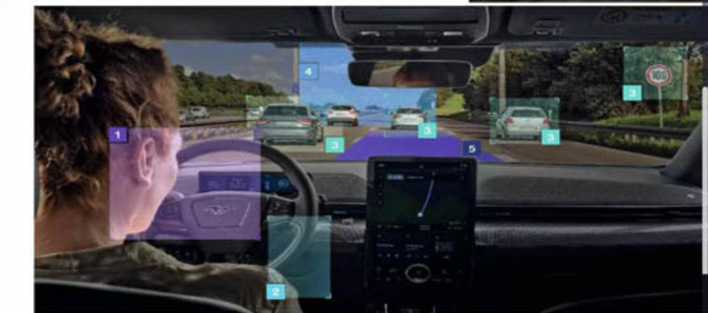
1 Eine Kamera prüft, ob man dem Verkehrsgeschehen aufmerksam folgt 2 Über eine Taste am Lenkrad lässt sich BlueCruise aktivieren und deaktivieren 3 Basis sind Daten wie Geschwindigkeitsbegrenzungen und sich ändernde Verkehrsbedingungen 4 Ein angemessener Abstand zu anderen Autos wird automatisch eingehalten 5 Zudem hält das System den Wagen in der eigenen Fahrspur
