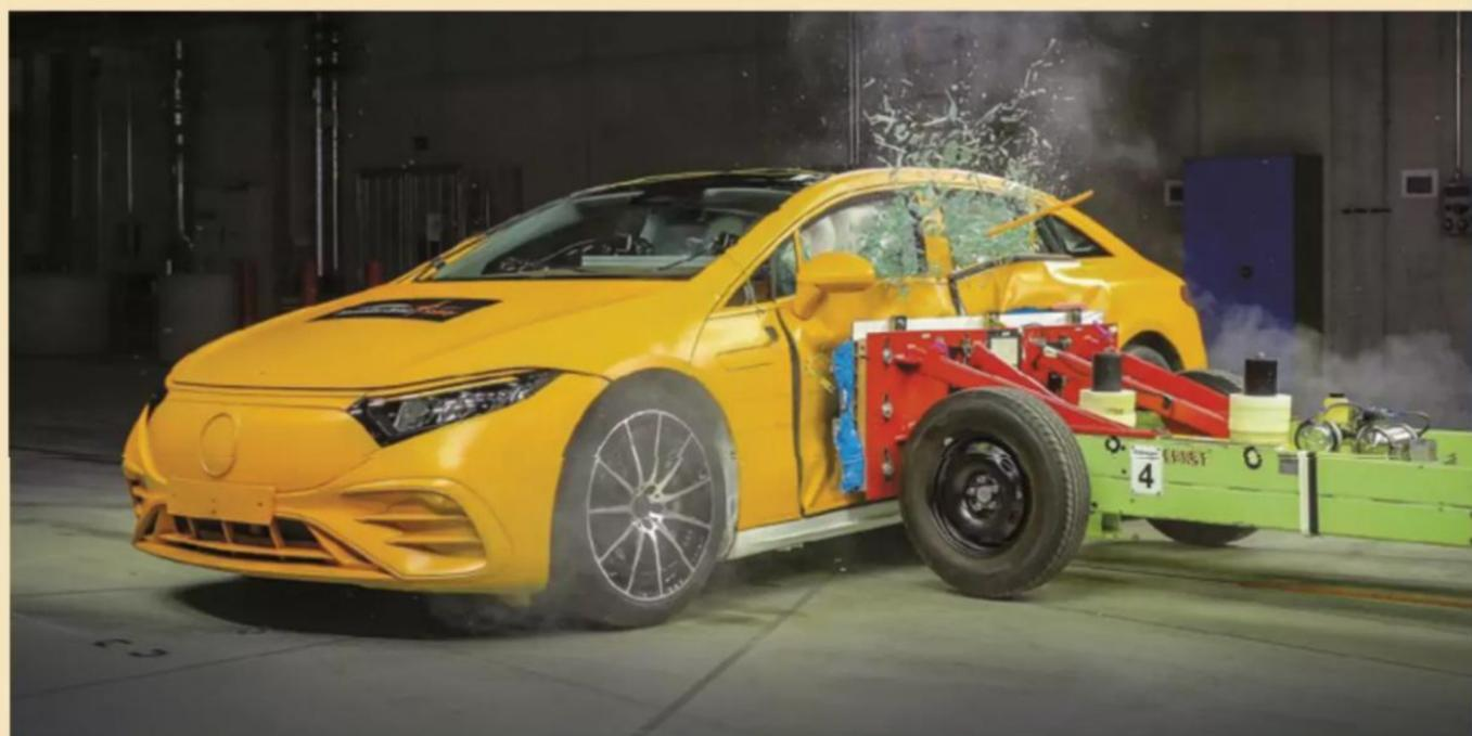
**Batteriegehäuse und Fahrzeugstruktur sind so aufeinander abgestimmt, dass die Sicherheitsanforderungen an die Batteriesicherheit erfüllt werden**
