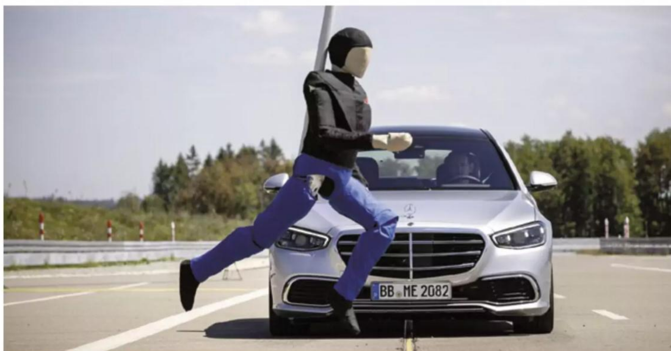
Der serienmäßige Aktive Brems-Assistent kann in bestimmten Situationen Kollisionsgefahren erkennen, Warnungen aussenden und bis hin zu einer autonomen Vollbremsung unterstützen
