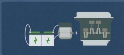
Hybrid-Fahrzeuge verfügen über zwei Energiequellen: Verbrennungs- und Elektromotor. Im Gegensatz zu Mild-Hybrid-Fahrzeugen können sie jedoch automatisch zwischen Verbrennungs- und Elektroantrieb (für kurze Distanzen) wechseln oder beide verwenden.
