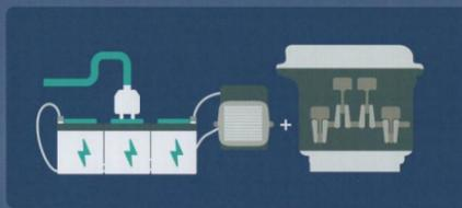
Ähnlich wie Hybrid-Fahrzeuge sind auch Plug-in-Hybride mit zwei Energiequellen ausgestattet. Sie verfügen jedoch über eine größere Hochvoltbatterie, mit der sie auch über längere Distanzen rein elektrisch fahren können. Das Aufladen erfolgt entweder über ein Stromkabel, durch das regenerative Bremsen oder durch die reine Motorkraft.
